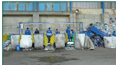
Pohled na ruční dotříd'ovací linku. Na pásu jedou pomalu všechny plastové odpady. Ručně je potom pracovníci třídící linky roztríd'ují podle druhu (PET lahve, silnostěnné plasty od obalů mycích a pracích prostředků, nápojové kartony) a podle barev (čiré, zelené, modré).
