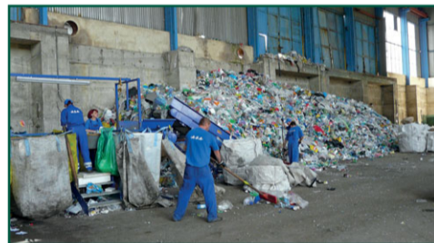
Na začátku dotříd'ovací linky je obrovská halda plastů a kartonových obalů, které jsou navezeny auty ze žlutých kontejnerů.
