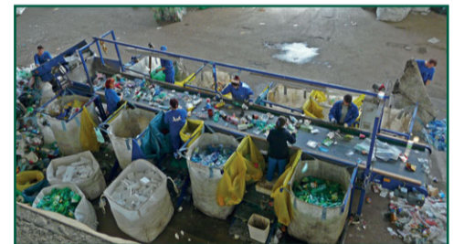
Pohled na ruční dotříd'ovací linku. Na pásu jedou pomalu všechny plastové odpady. Ručně je potom pracovníci třídící linky roztríd'ují podle druhu (PET lahve, silnostěnné plasty od obalů mycích a pracích prostředků, nápojové kartony) a podle barev (čiré, zelené, modré).
